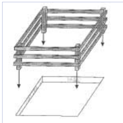
Barandilla en hueco interior
